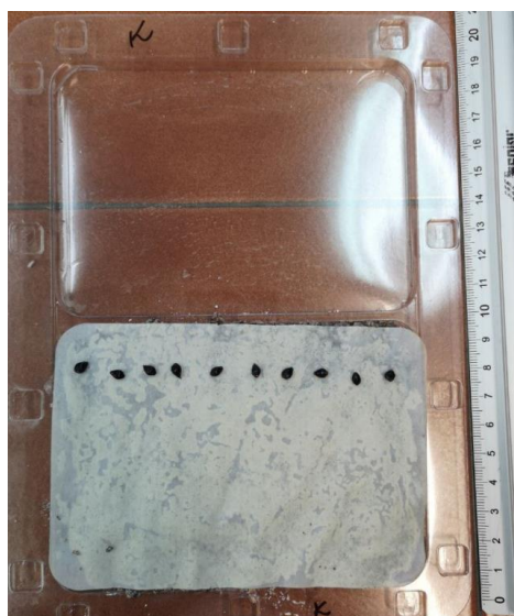
Fotografia 3. Płytki testowe w teście Phytotoxkit.
